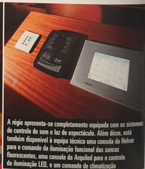
A régie apresenta-se completamente equipada com os sistemas de controlo de som e luz de espectáculo. Além disso, está também disponível à equipa técnica uma consola da Helvar para o comando da iluminação funcional das sancas fluorescentes, uma consola da Arquiled para o controlo da iluminação LED, e um comando de climatização
